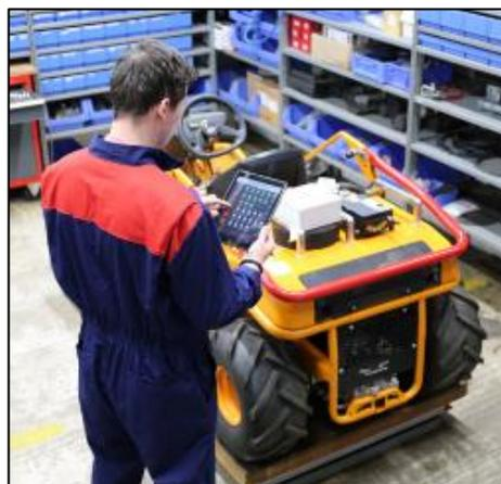
**Bild 2:** Das Diagnosegerät AS SherLog 1.0 ermöglicht dem servicegebenden Fachhändler eine Prüfung innerhalb weniger Minuten in der Werkstatt oder vor Ort
