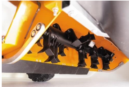
Bild 4: Schlegelmähwerk des AS 1040 Yak 4WD
