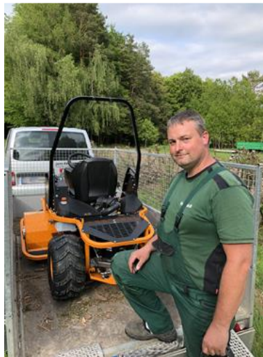
Bild 2: Auffällig: In Fahrtrichtung links kragt das asymmetrisch angeordnete Schlegelmähwerk des AS 1040 Yak 4WD aus
