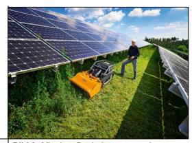
**Bild 2:** Mit einer Bauhöhe von gerade einmal 59 Zentimetern ist der AS 751 RC prädestiniert für Mäharbeiten unter Photovoltaikanlagen
