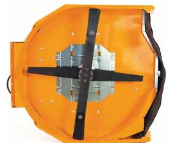
Die unteren Messer sind beweglich. Hier ist zusätzlich das optionale Mulchkit angebracht, das die flächige Ablage des Mähguts verbessert.
